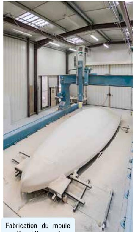
Fabrication du moule par Ouest Composites
