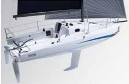
plus une option de motorisation électrique ingénieuse permet de conserver le même sail-drive que la motorisation thermique pour un poids identique avec une autonomie de 6H.
