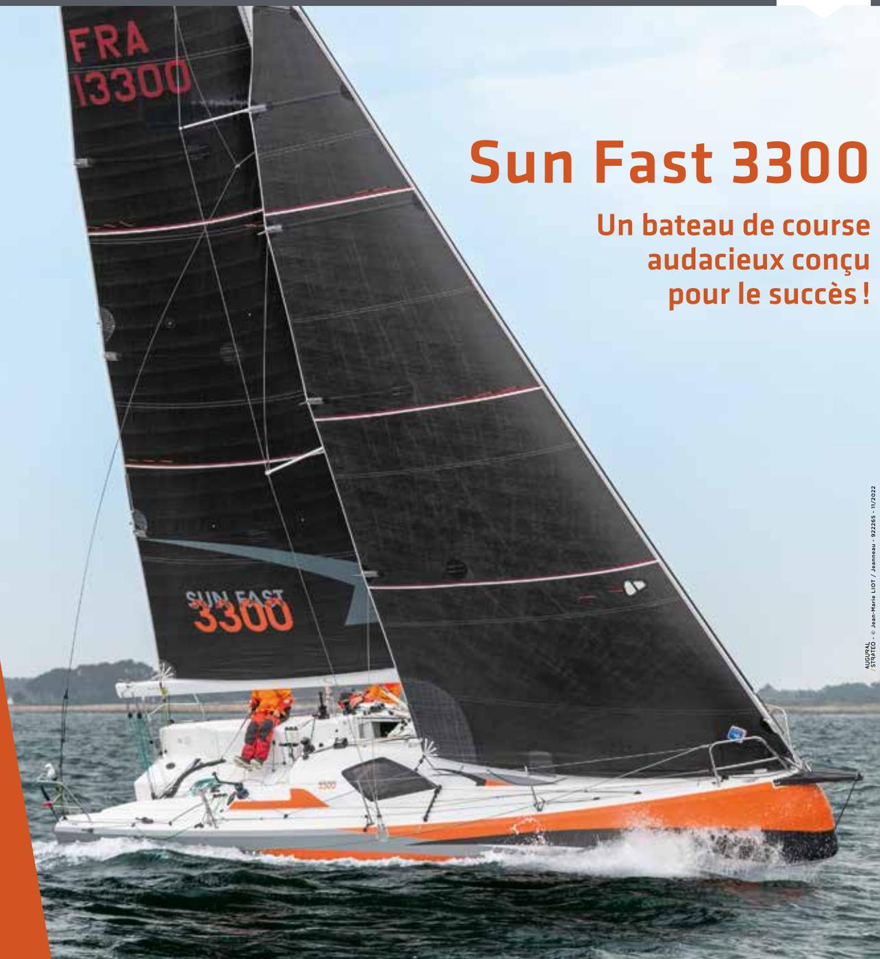
Dessiné par le duo [ANDRIEU|VERDIER] et construit intégralement en infusion, le Sun Fast 3300 bénéficie d'une carène moderne avec double concavité, d'une résistance et d'une rigidité exceptionnelles, avec un poids considérablement réduit. Grâce à sa coque puissante et légère, ses doubles safrans et sa quille droite, ce Sun Fast conjugue vitesse et stabilité de route à toutes les allures.
