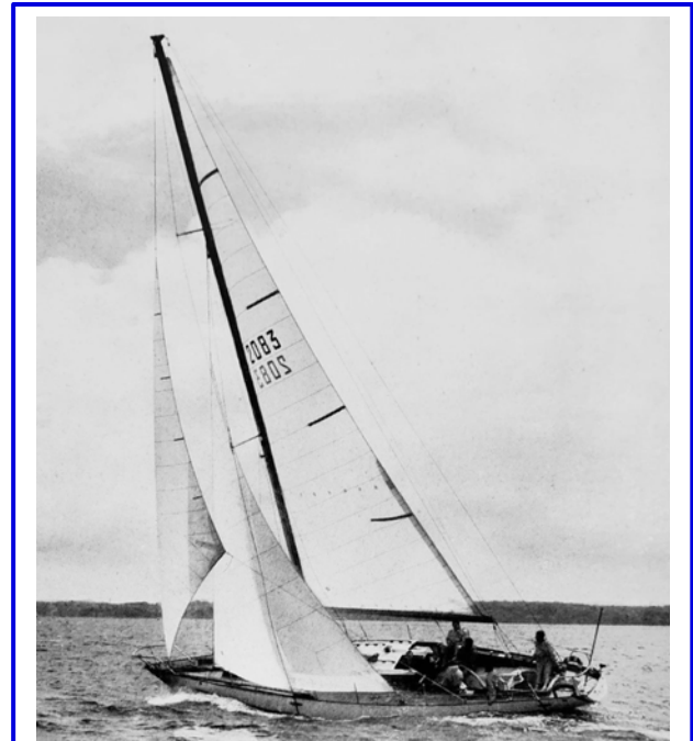
Glénan , construit à Concarneau pour le Centre Nautique des Glénans sur un plan d'Illingworth. Il termine 2 ème de la Channel race en 1962. LHT 13m, LWL 10.4m, Bau 3.23m, TE 2.22m DSPL 8.8 T, SA 72.80 m 2
